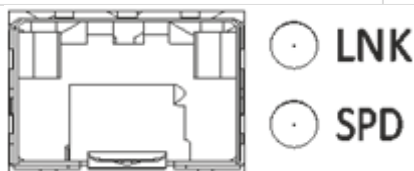
Рисунок 71 – Расположение индикаторов разъема SFP
