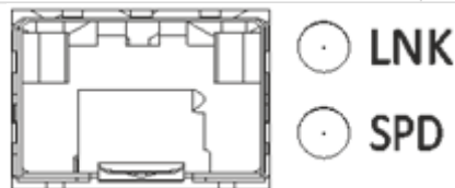
Рисунок 67 – Расположение индикаторов разъема SFP
