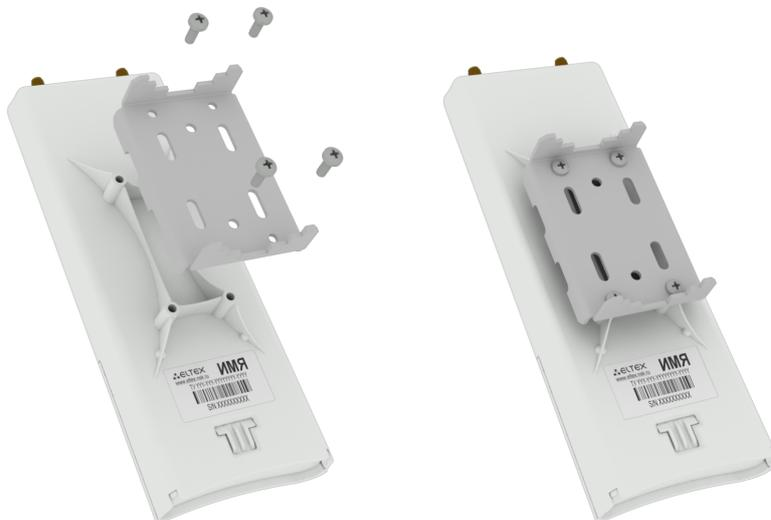
2. Установите устройство Ethernet-портом вниз на трубостойку как показано на рисунке ниже и закрепите его хомутами, идущими в комплекте с устройством. Соблюдайте инструкции по технике безопасности и рекомендации, приведенные в разделах [«Инструкции по технике безопасности»](#) и [«Рекомендации по установке»](#).
