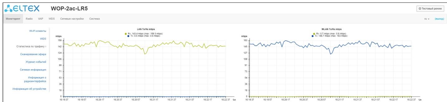
График LAN Tx/Rx показывает скорость приема/передачи трафика через Ethernet интерфейс точки доступа за последние 3 минуты. График автоматически обновляется каждые 2 секунды.
