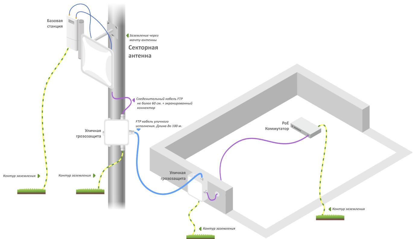
Схема подключения базовой станции для обеспечения грозозащиты
