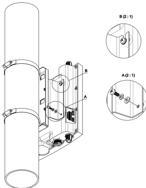
Рисунок 10 – Крепление устройства на трубостойке
