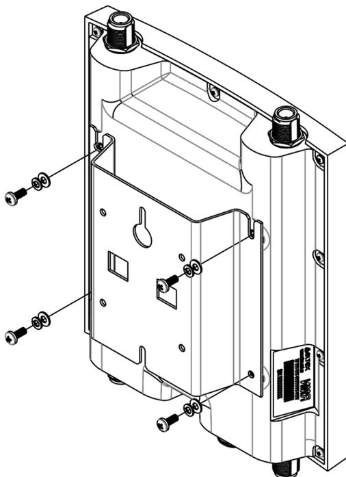
Рисунок 11 – Крепление кронштейна
