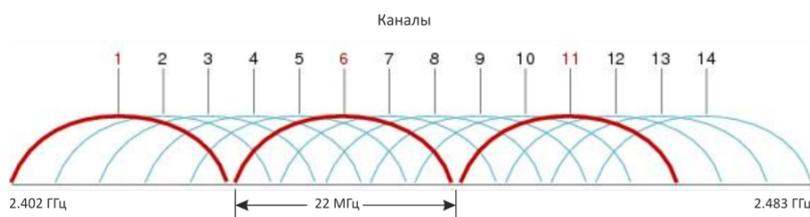
Рисунок 3 – Общая диаграмма перекрытия частотных каналов в 2.4 ГГц
