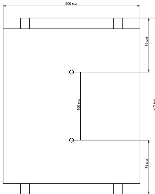
Рисунок 13 – Габариты устройства относительно крепежных отверстий
