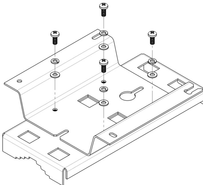
Рисунок 7 – Кронштейн для крепления на трубостойку
