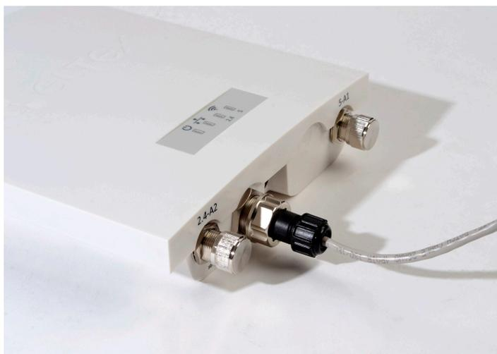
Рисунок 23 – Вид подключенного кабеля к сетевому интерфейсу устройства
