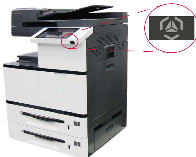
Рисунок 23 – Кнопка включения МФУ «Гравитон»
