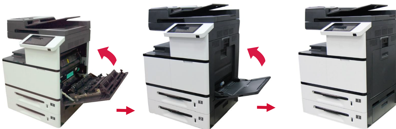
Рисунок 19 – Закрытие боковой дверцы
