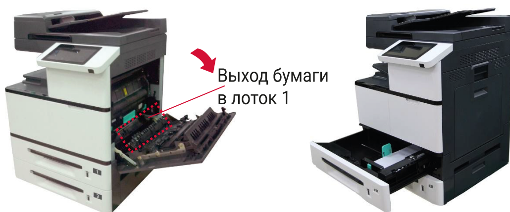
Рисунок 79 – Замятие бумаги в лотке 1
