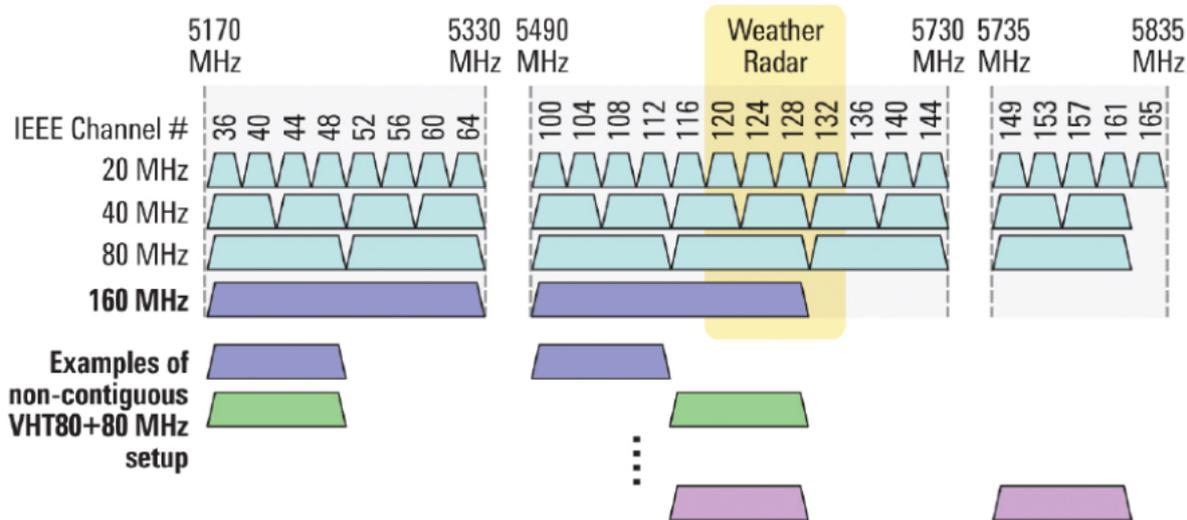
Рисунок 8 – Каналы, используемые в диапазоне 5 ГГц при ширине канала 20, 40, 80 МГц
