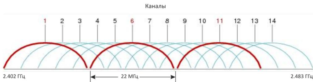
Рисунок 5 – Общая диаграмма перекрытия частотных каналов в 2.4 ГГц
