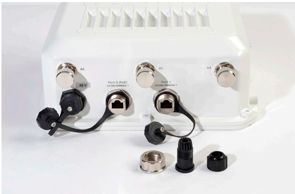
Рисунок 14 – Герметичный разъем RJ-45 на устройстве и ответная часть в разобранном виде
