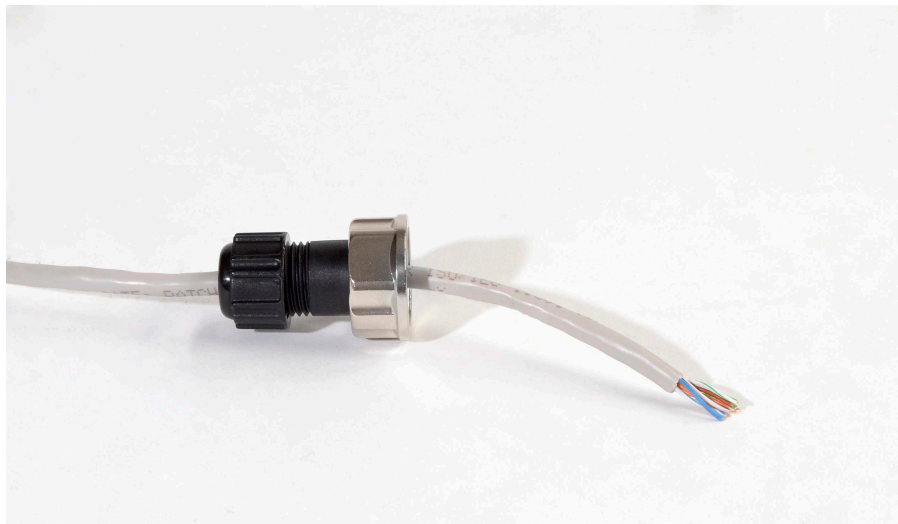
Рисунок 16 – Крепление ответной части на кабеле
