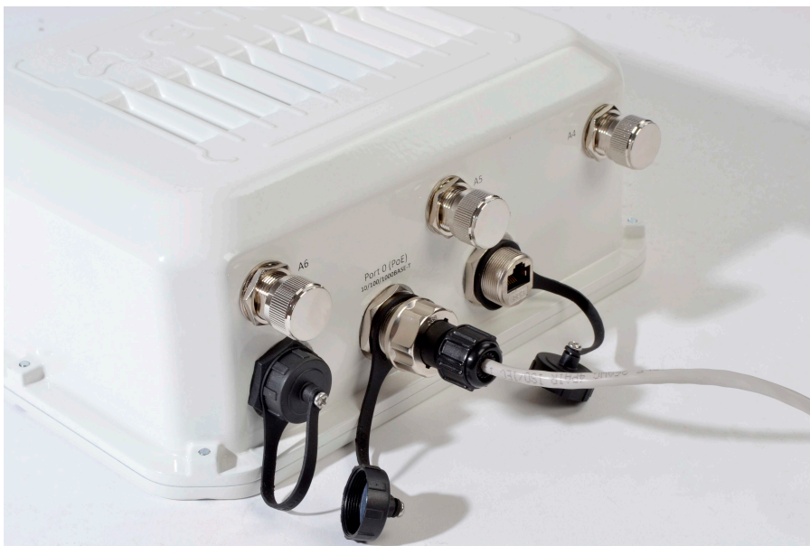
Рисунок 19 – Вид подключенного кабеля к сетевому интерфейсу устройства
