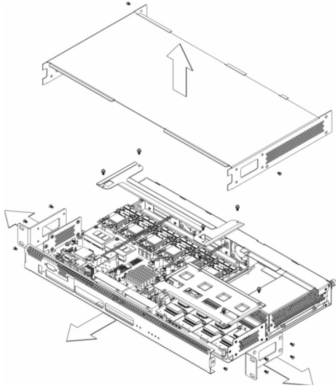
Рисунок 22 – Порядок вскрытия корпуса SMG-1016M
