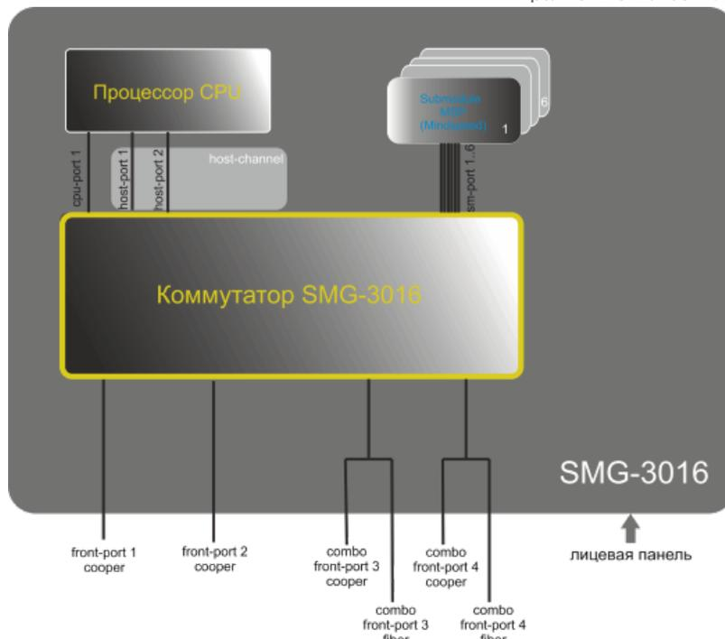
Рисунок 49 – Структура коммутатора
