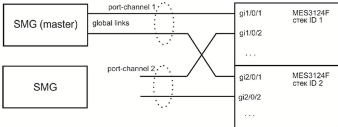
Рисунок 57 – Схема подключения ведущей SMG (master)
