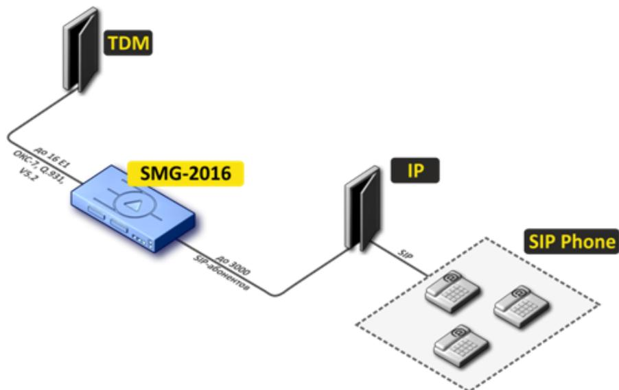
Рисунок 4 – Мини IP-PBX на базе SMG-2016
