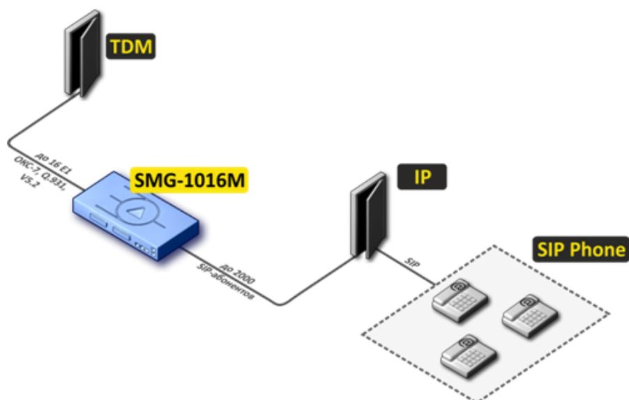
Рисунок 3 – Мини IP-PBX на базе SMG-1016M
