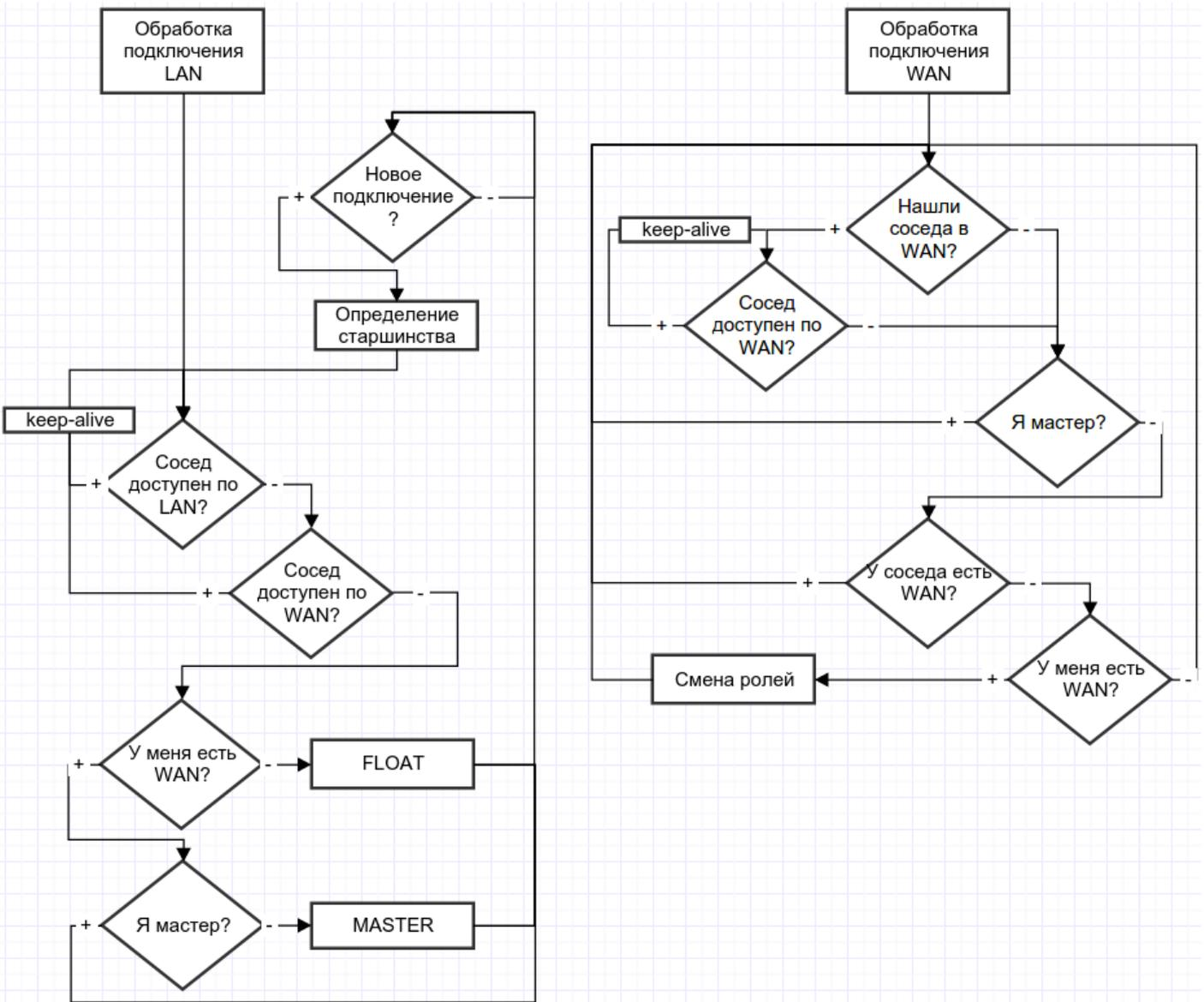
**⚠** При подключении устройства к уже работающему, необходимо отключить все WAN-линки на подключаемом устройстве, подключить LAN-линк к работающему (MASTER) SMG, дождаться согласования, подключить WAN-линки к SLAVE, иначе вновь подключаемое устройство может определиться как MASTER и передать свои неактуальные рабочие файлы.
