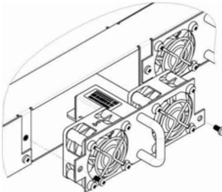
Рисунок 33 – Блок вентиляции SMG-2016. Крепление в корпус
