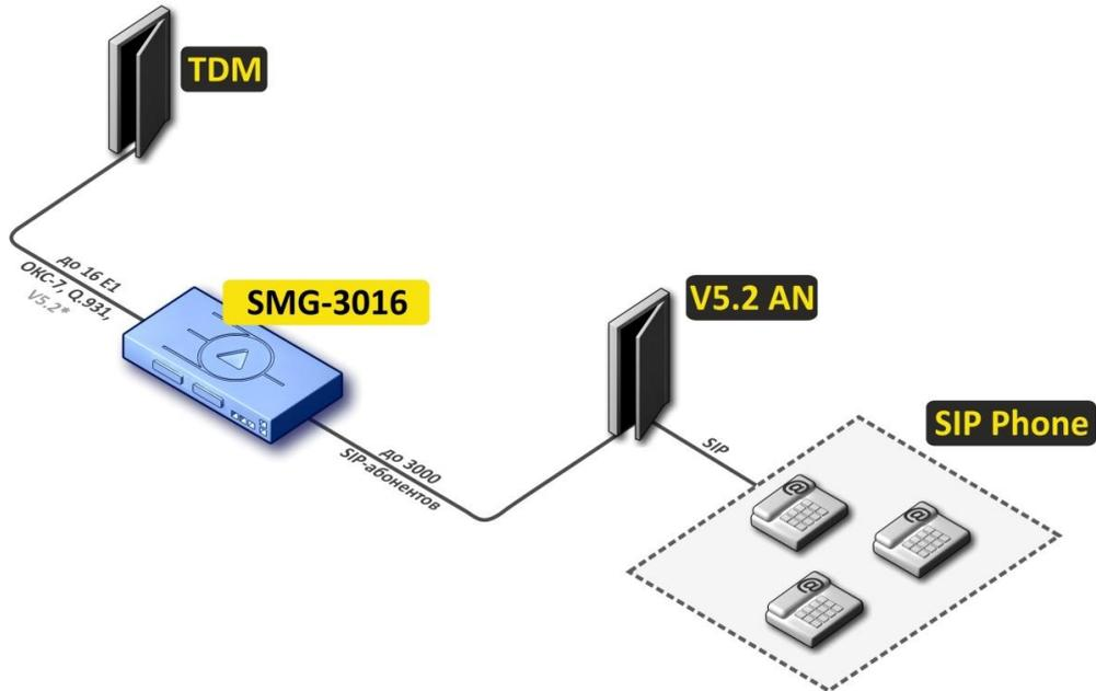
Рисунок 8 – Вынос V5.2 AN на базе SMG-3016
