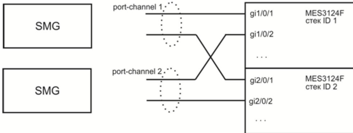
Рисунок 56 – Схема объединения портов в port-channel
