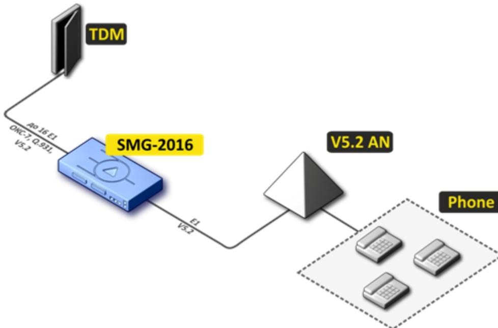
Рисунок 7 – Вынос V5.2 AN на базе SMG-2016
