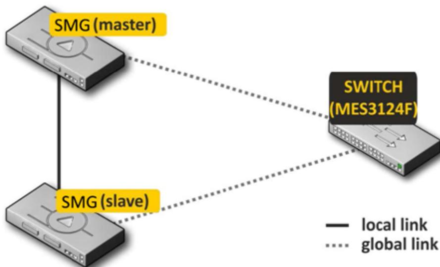
Рисунок 54 – Схема резервирования с одним коммутатором
