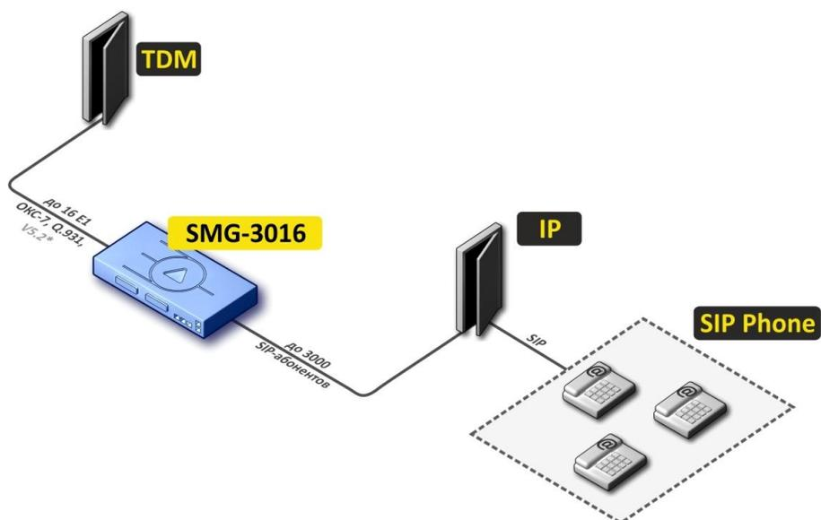
Рисунок 5 – Мини IP-PBX на базе SMG-3016
