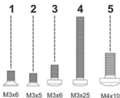
Рисунок 25 – Типы болтов для сборки SMG
