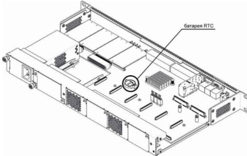
Рисунок 42 – Положение батареи RTC для SMG-1016М
