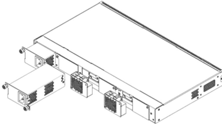
Рисунок 32 – Блок вентиляции SMG-1016M. Крепление в корпус
