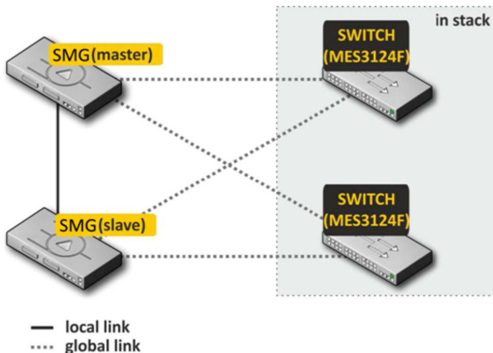
Рисунок 55 – Схема резервирования двумя коммутаторами в стеке
