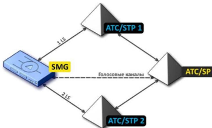
Рисунок 48 – Схема подключения SMG в комбинированном режиме
