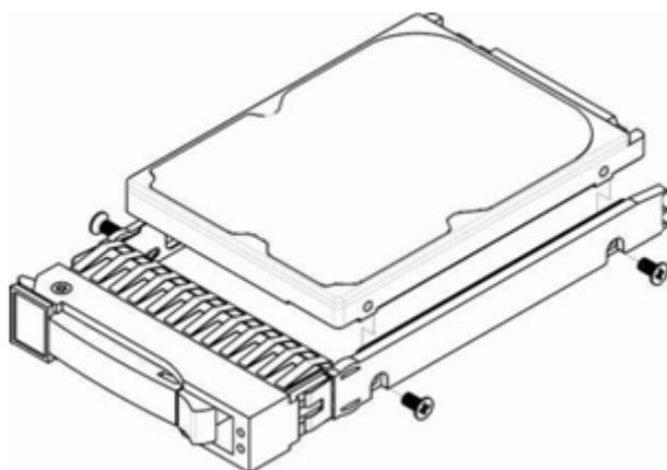
Рисунок 40 – Крепление SATA-диска в лоток направляющих салазок
