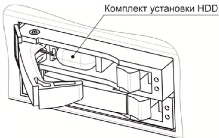
Рисунок 39 – Расположение комплекта крепежных элементов при поставке
