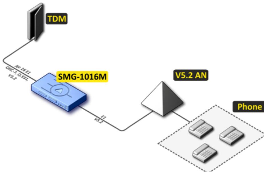
Рисунок 6 – Вынос V5.2 AN на базе SMG-1016M
