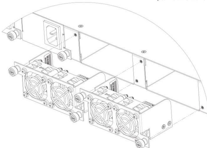
Рисунок 35 - Блок вентиляции SMG-3016. Крепление в корпус
