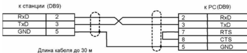
Рисунок 52 – Схема кабеля для подключения к ПОРТ1, ПОРТ2
