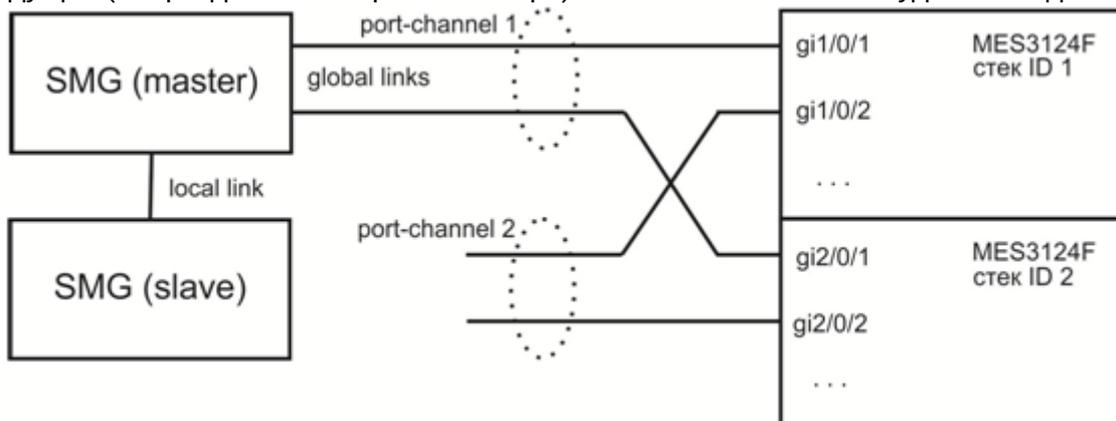
Рисунок 58 – Схема подключения ведомого SMG (slave)
