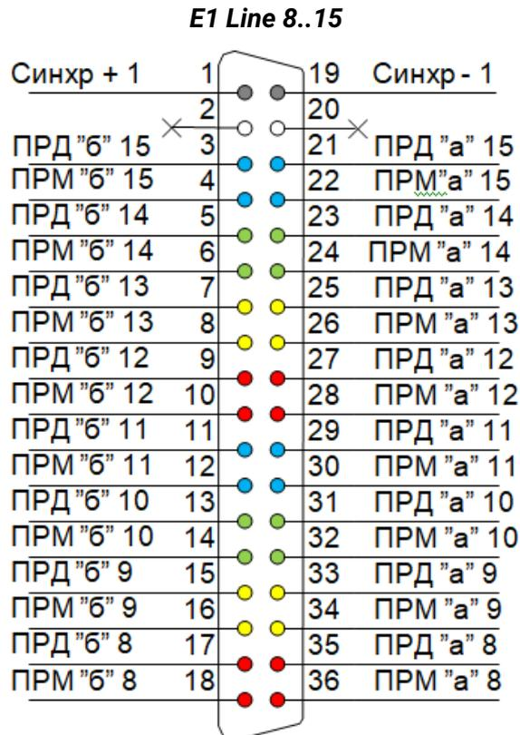
Рисунок 50 – Назначение контактов разъемов E1 Line
