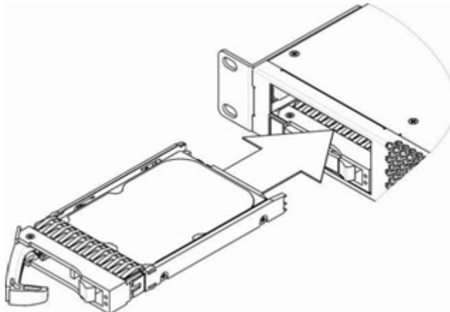
Рисунок 41 – Монтаж SATA-диска в корпус устройства
